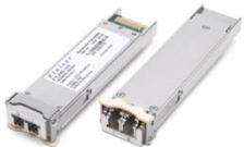
Longitud de onda: 850nm o 1300nm para las aplicaciones multimodo (SFP 1000Base-SX). 1310 (SFP 1000Base-LX) o 1550nm (SFP 1000Base-ZX) para las aplicaciones monomodo. Versiones Monofibra 1310/1550 nm CWDM (1470 nm a 1610 nm) y DWDM (banda C) también están disponibles.
