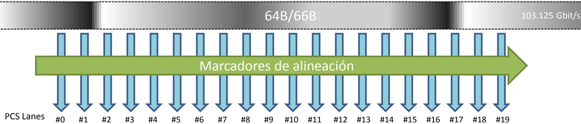
**El control del « skew » : 180 ns de retrasado tolerado entre PCS lanes**
